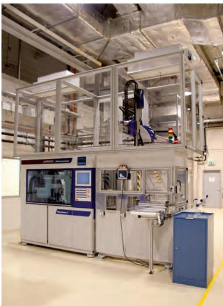
**Bild 4: Mikrospritzgießanlage speziell angepasst für die Herstellung von Mikrooptiken [7]**
