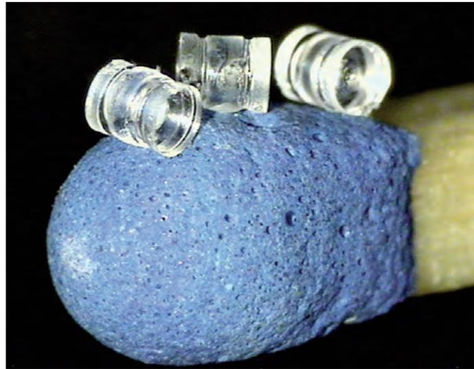
**Bild 5: Asphärische Mikrolinsen aus der Mikrospritzgießfertigung**
