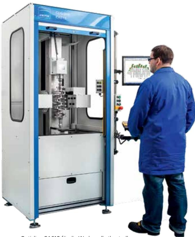
Opticline CA618 für die Werkerselbstkontrolle
