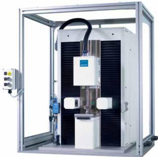
Opticline CA305 mit kundenspezifischer Umhausung, optimiert für das Messen von Turboladern in der Automatisierung
