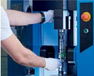
Werkstückgewichte bis zu 15 kg können mit der Opticline CS-Serie gemessen werden
