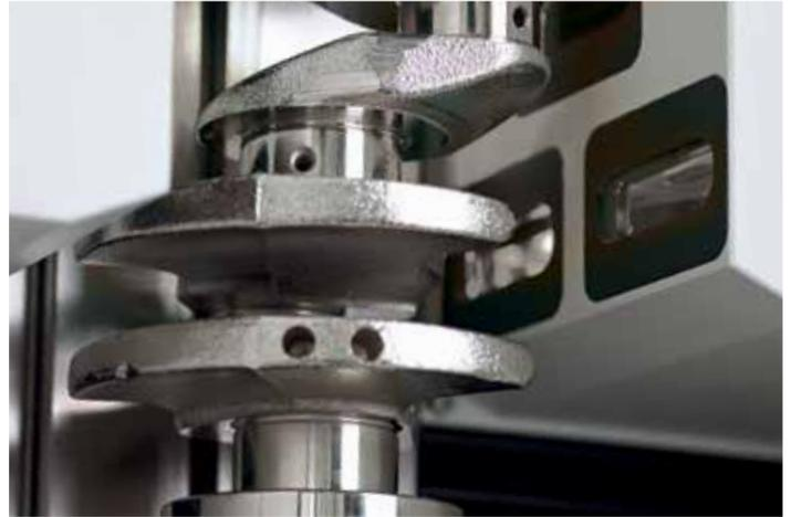
Messen von Kurbelwellen mit der Opticline C1023-75AE
