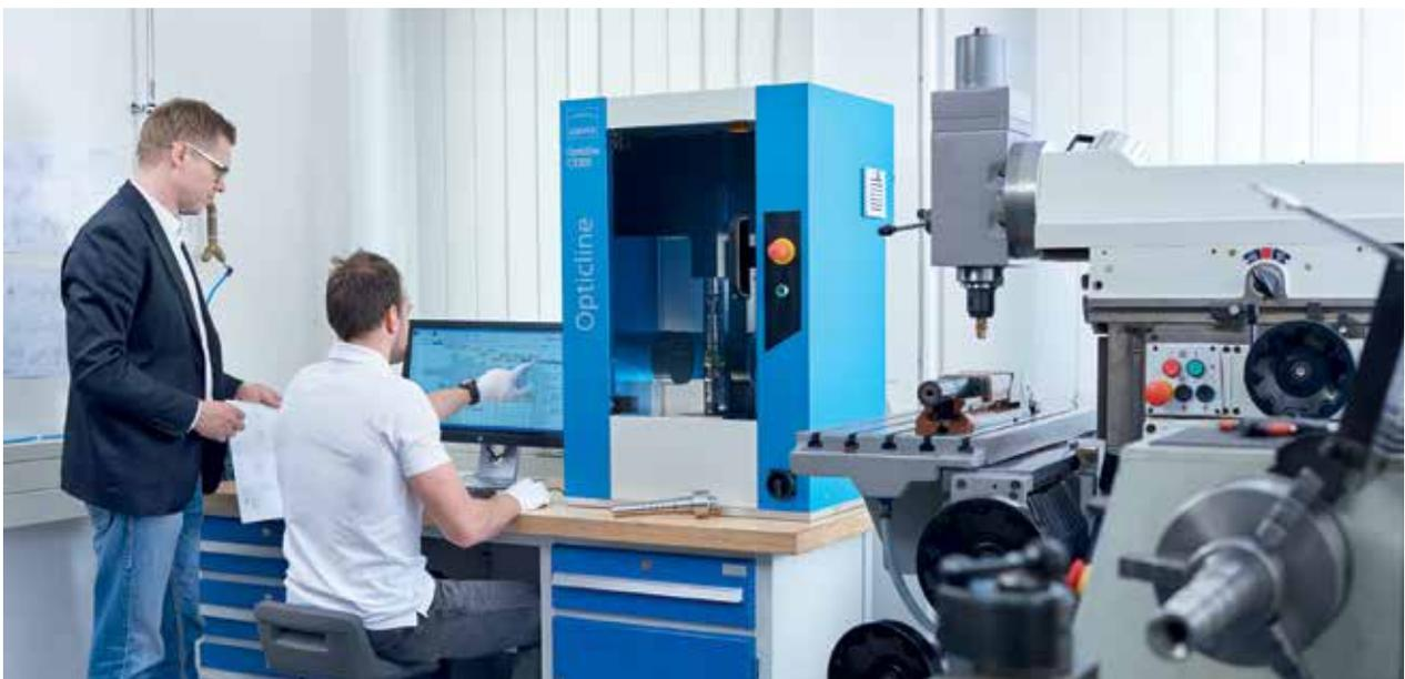
Opticline CS305 für die wirtschaftliche Messung von Drehteilen mit einer Länge von bis zu 300 mm
