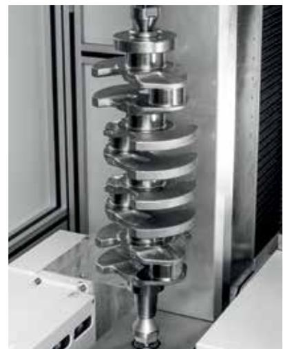
Opticline CA618-AE für die Kurbelwellenmessung
