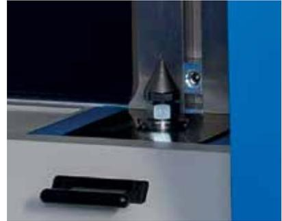
Flexible Werkstückaufnahme über Morsekegel MK2 für eine schnelle Umrüstung
