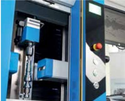
Integrierte Lichtschranke zum Schutz des Werkers gemäß internationalen Sicherheitsstandards
