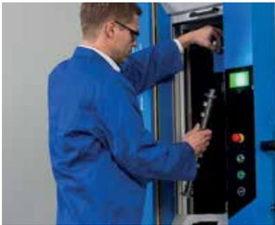
Einfache Bedienung der Messmaschine dank Reitstockschnellverstellung
