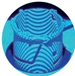
*Dank der berührungslosen 3D-Digitalisierung können bereits produzierte Teile einfach und schnell mit digitalen Soll-Modellen verglichen werden. Dadurch werden fertigungsbedingte Abweichungen schnell sichtbar.*
