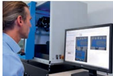
*Während des automatischen Scanprozesses wird ein 3D-Modell aus vielen verschiedenen Ansichten ohne Referenzmarken hochgenau zusammengesetzt. Diese Innovation überzeugte die Jury der Jenoptik-Innovationswerkstatt.*
