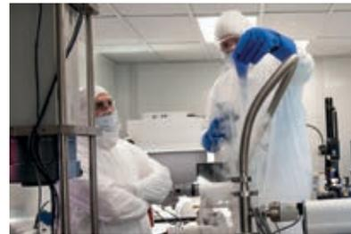
*Aufgrund der Nähe der Kamera zu den gesammelten Mars-Proben waren die Reinheitsanforderungen an unsere Objektive extrem hoch. Daher fertigte unser Team alle drei Objektivtypen in einem Reinraum der Klasse 5, der mit modernster Filtertechnologie für hochpräzise optische Baugruppen ausgestattet ist. Nur so können mögliche Kontaminationen und Fehlmessungen der Proben vermieden werden.*
