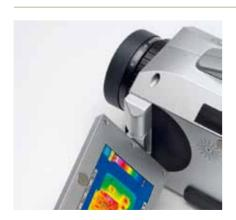
Die Thermografiekameras der Produktreihe VarioCAM® zeichnen sich durch eine hohe Bildauflösung (3 Megapixel) und eine sehr präzise Darstellung von Temperaturunterschieden (bis zu 1/20stel Grad Celsius) aus. Damit können zum Beispiel selbst kleinste thermische Leckstellen in Gebäuden effizient ermittelt und dargestellt werden. Aufbauend auf diesen Messungen sind zielgenaue Sanierungsmaßnahmen zur Verbesserung der Gebäudedämmung verbunden mit einer hohen Energieeinsparung möglich.
