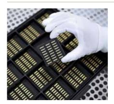
Das Halbleitermaterial von Jenoptik zeichnet sich aus durch eine lange Lebensdauer von 30.000 Stunden (entspricht 4,5 Jahren) und einen besonders hohen Wirkungsgrad von bis zu 70 Prozent. Im Vergleich dazu steht der Wirkungsgrad einer herkömmlichen Glühlampe bei rund 5 Prozent und der einer Energiesparlampe bei etwa 25 Prozent. Zudem ist dieses Material mit seinem kleinen Volumen auch extrem zuverlässig (Ausfallrate unter 0,5 Prozent) und kostengünstig in der Fertigung.
