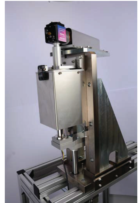
Der Testaufbau (Factory Acceptance Test) des optischen Systems, bei Jenoptik in der von Contexo gestellten Halterung
