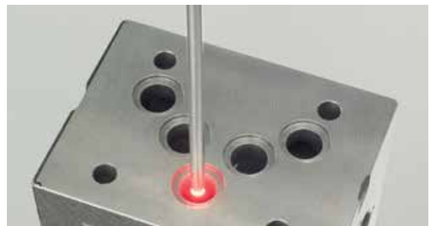
Inspektion der Bohrungsinnenfläche eines mobilen Hydraulikblocks
