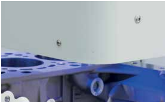
Planflächenprüfung mit dem IPS F100 3D
