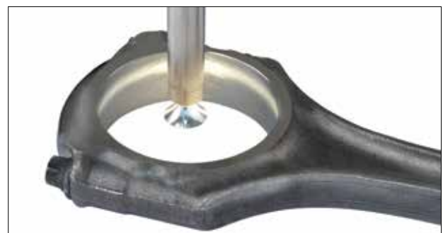
Prüfung der Innenbohrung eines Pleuel-Auges
