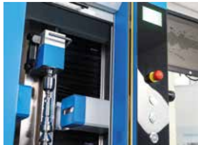
Integrierte Lichtschranke zum Schutz des Werkers gemäß internationaler Sicherheitsnormen
