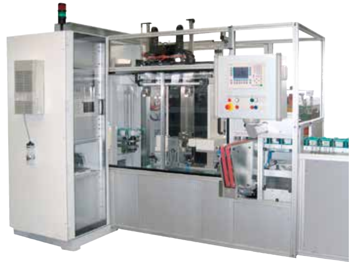
Opticline VMS305 für das Messen von Motorventilen, integriert in eine Fertigungsanlage
