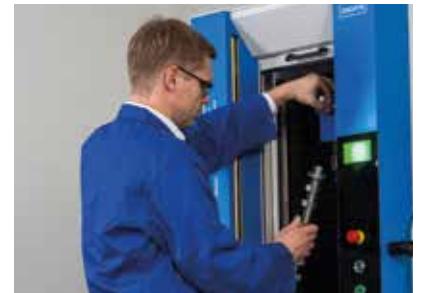
Einfache Bedienung der Messmaschine dank Reitstockschnellverstellung
