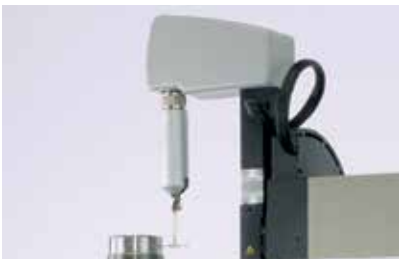
MDS4 mit beidseitig wirkendem Tastsystem
