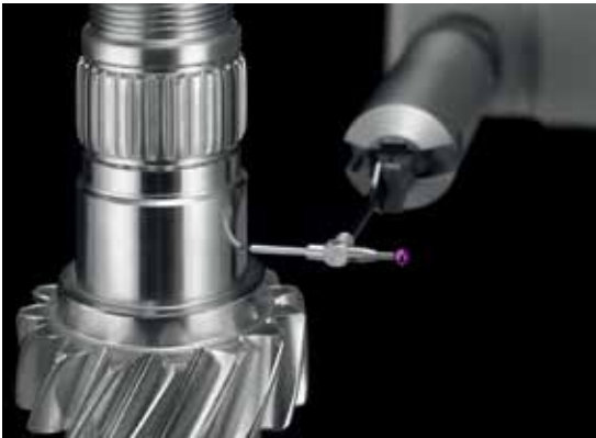
Drallmessung mit einer Rauheitstastspitze
