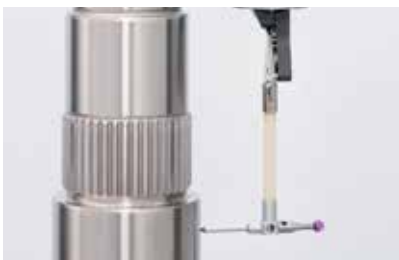
Rauheits- und Formmessung mit beidseitig wirkendem Tastsystem
