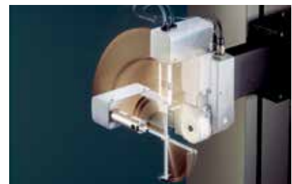
Motorisches Dreh- und Schwenkmodul MDS für vollautomatische Messungen (Option)
