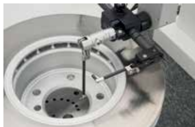
Sondermessplatz für spezifische Aufgaben bei der Bremsscheibenmessung
