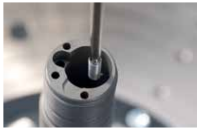
Formmessung in tiefen, engen Bohrungen
