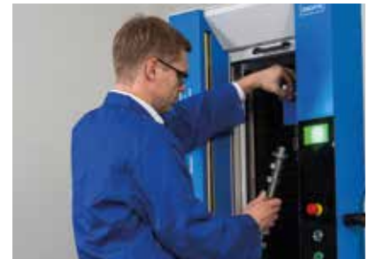
Einfache Bedienung der Messmaschine dank Reitstockschnellverstellung
