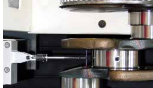
Optionales, taktiles Tastsystem BTS mit zusätzlichen Auswertmöglichkeiten für konzentrische Längen und Planläufe
