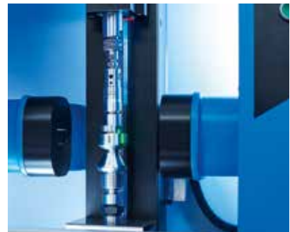
Einfaches Spannen des Werkstücks zwischen Spitzen
