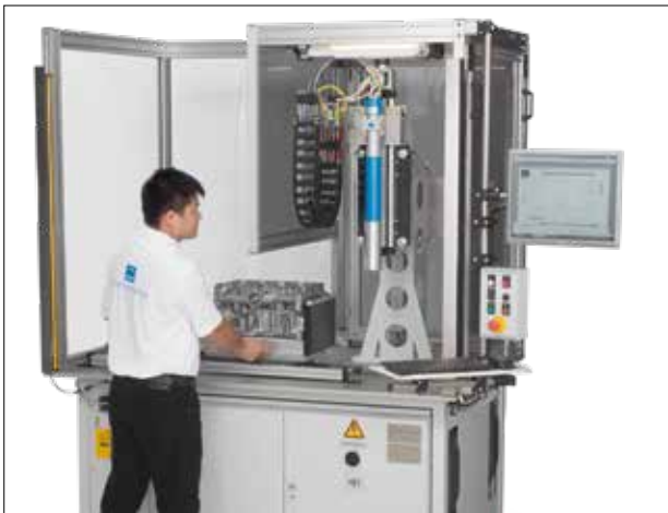
Prüfplatz mit manueller Beladung für Kleinserien-/Prototypenfertigung
