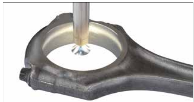
Prüfung der Innenbohrung eines Pleuel-Auges
