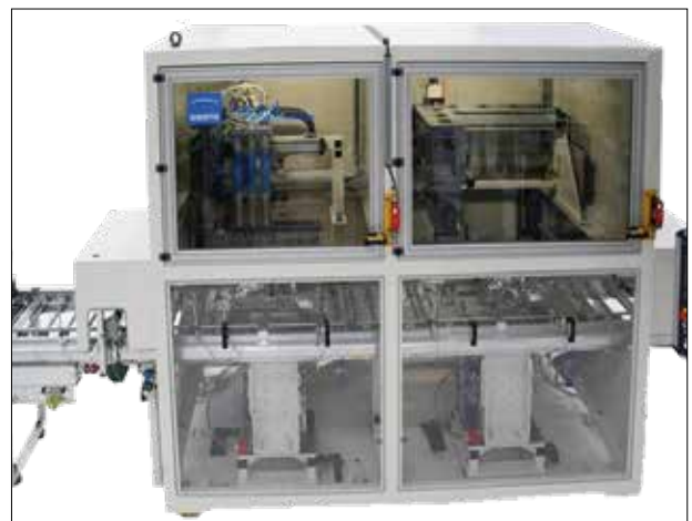
100-Prozent-Prüfung von Zylinderbohrung und Planfläche am Motorblock
